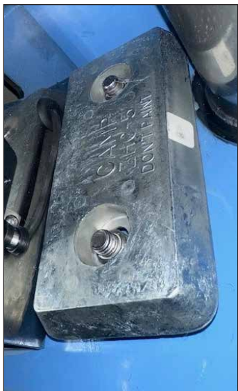
Sacrificial zinc anode.
